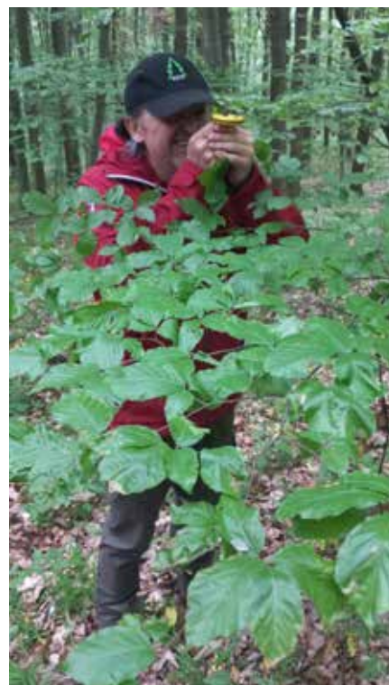
2. kép Közelítő nyom kitűzése zsebbusszal
