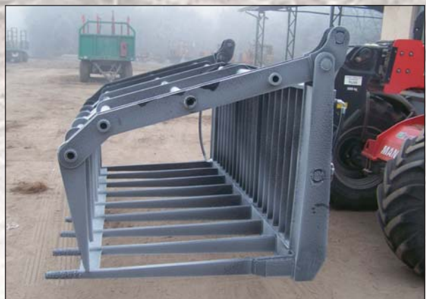
2. ábra. A gép prototípusa, a VT-02 típusú vágástakarító gép
