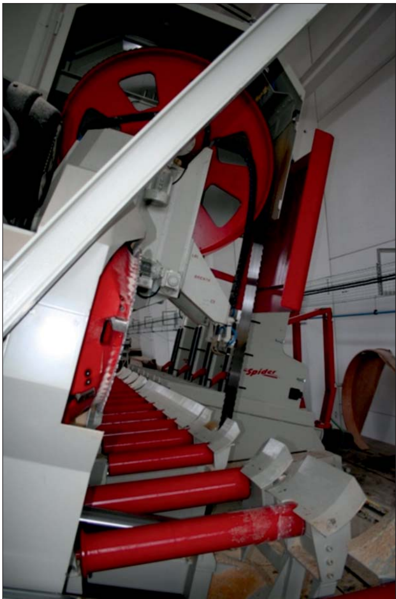
Akár napi 350 köbméter fát is képes föl vágni ez a fűrész
