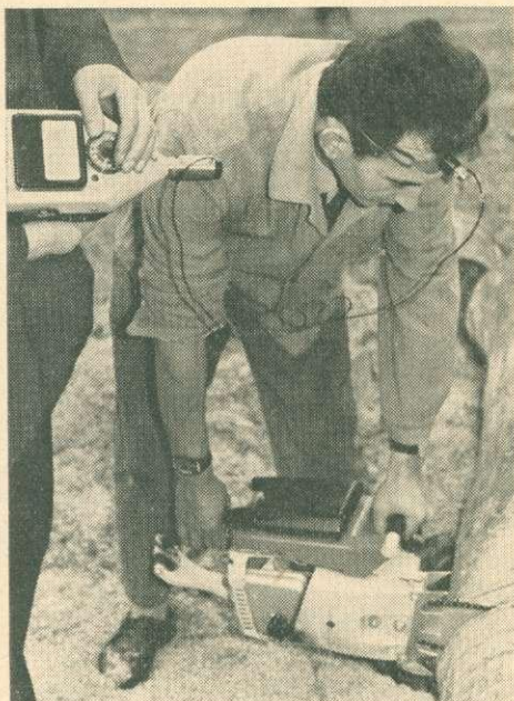
1. ábra. A motorfűrész rezgésének és a rezgés áttérjedésének mérése
