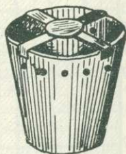
7. ábra. Boltonrendszerű fűtő- edény. (J. M. Jaroszlavcev : Talajmenti fagy)
