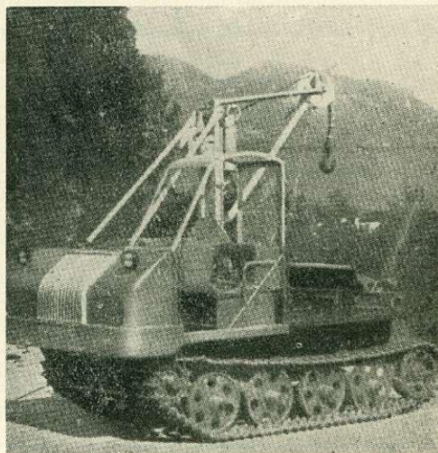
M. 70. MOTORMULI csörlővel, daruval és forgószármollyal
