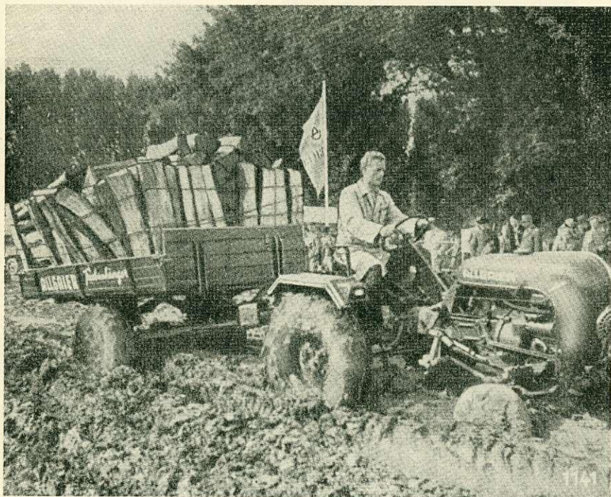
ALLGAIER 12 LE-s léghűtéses vontató meghajtott tengelyű pótkocsival
