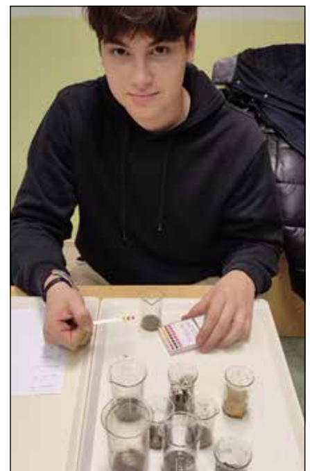
4. kép Indikátorpapírral történő pH-meghatározás
