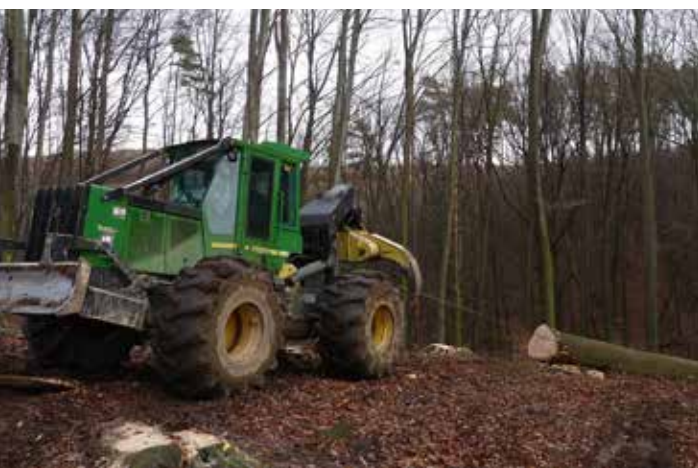
5. ábra Vonszolásos közelítés, csörlős-markolós erdészeti géppel (Fotó: Fitos Balázs, forrás: Erdő-Mező Online)
