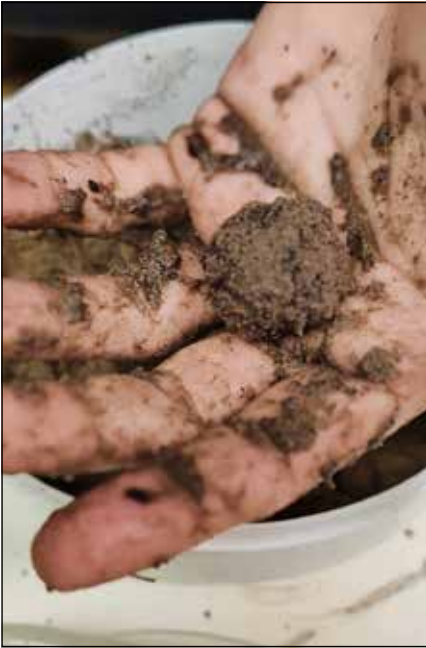
5. kép A gyűrőpróba eredménye szürke nyár alól származó minta esetén
