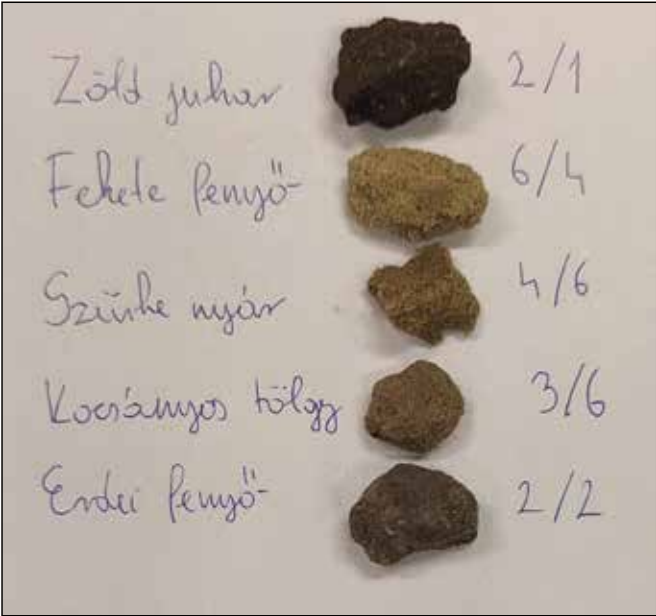
8. kép Talajszín-meghatározás a Munsell-skála alapján, a felszín közelében vett minta esetében
