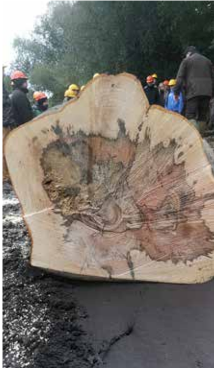
2. ábra Álgesztes bükk faanyag, soproni heggyvidék (Fotó: Szakálosné Mátyás Katalin)
