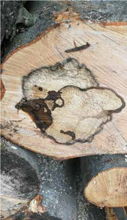
2. ábra Álgesztes bükk faanyag, soproni heggyvidék (Fotó: Szakálosné Mátyás Katalin)
