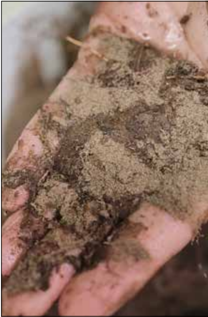
6. kép A gyűrőpróba eredménye fekete fenyő alól származó minta esetén
