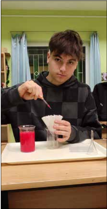
7. kép A talaj vízfelvevő képességének vizsgálata színezett vízzel
