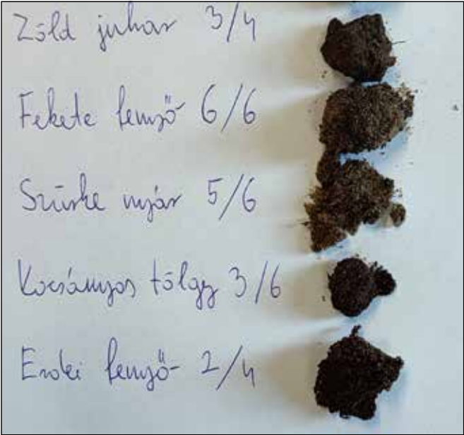
9. kép Talajszín-meghatározás a Munsell-skála alapján, az egy méter mélységből vett minta esetében
