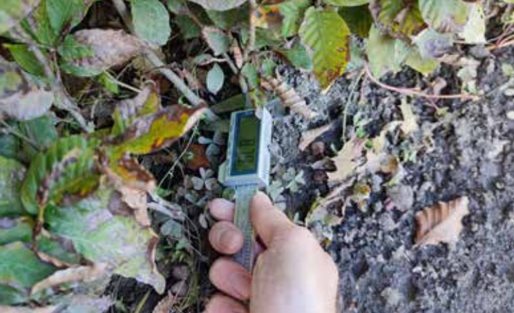
2. ábra A csemeték gyökfőátméréjének mérése digitális tolómérővel
