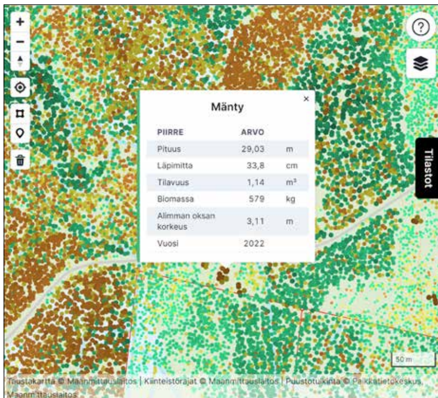
3. ábra Egyesfa-szintű erdészeti leíró adatok a Finn Erdőállomány Rendszerből. A képen a kiválasztott fa magassága, törzsátmérője, körlapösszege, biomasszája, legalsó ágának magassága és az adatfelmérés éve látszik. Forrás: Metsäkanta (2024)
