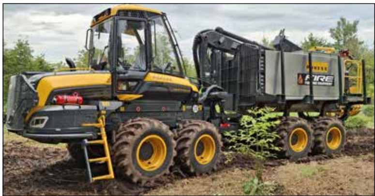
Erdőtűztöltő berendezés forwarder
