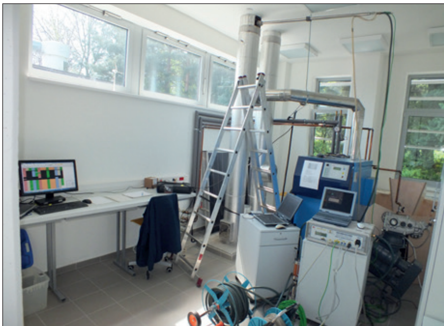
4. ábra A teljes tüzeléstechnikai mérőkör mérés közben
