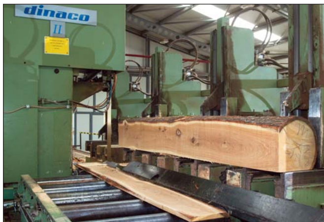
Dinaco típusú rönkvágó szalagfűrész a Franciaavágási Fűrészáru Gyárban
