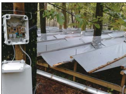
2. ábra. „MAD” csapadékkizárásos kísérlet, Sopron-Magashérc, Eredics A., 2014
