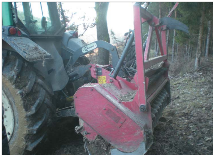
FM-500-2300 típusú vízszintes tengelyű szárzúzó
