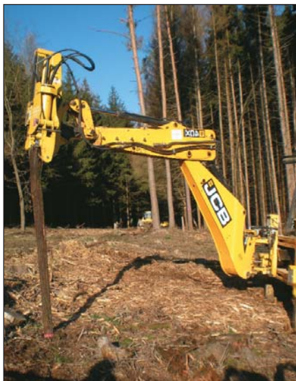
JCB 4CX kotró-rakodóra szerelt Vibrescopik cölöpverő adapter
