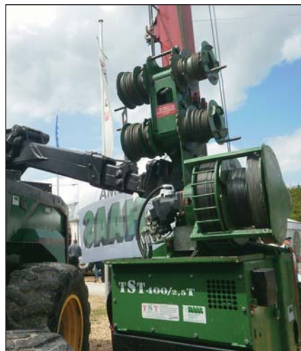
10. ábra. Timberjack harveszter TST 400 kötélpályával
