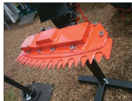
4. ábra. MenSe Clearing Blade
