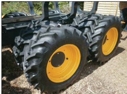
9. ábra. Ponsse szélesített járószerkezet
