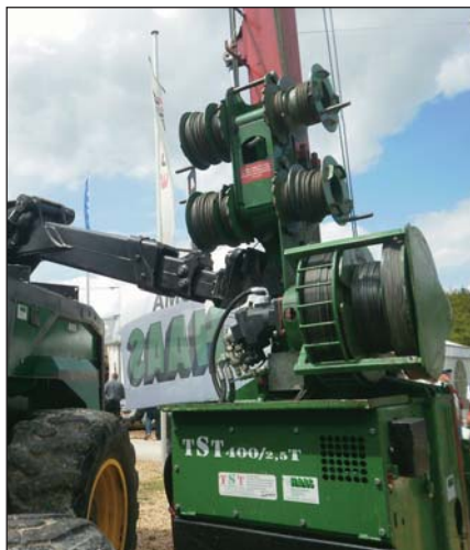
10. ábra. Timberjack harveszter TST 400 kötélpályával
