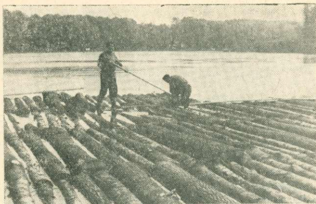
2. ábra. A „levelek” egymáshoz rögzítése
