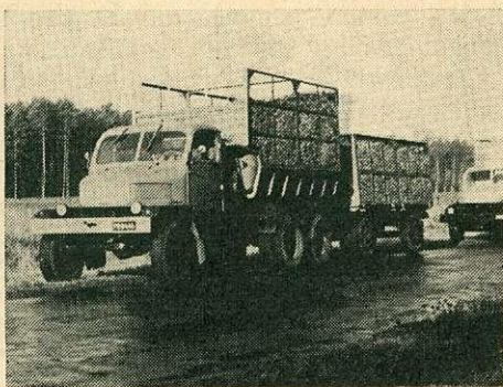
6. ábra: Praga V 35 típusú billenőplató tehergépkocsi (98 LE/72 kW-os benzinüzemű motor, teherbírás 5 t, 3,5 t-s billenő pótkocsi kézi-hidraulikus üzemű, a gépkocsi billenőszekrényét a motor üzemelteti)
