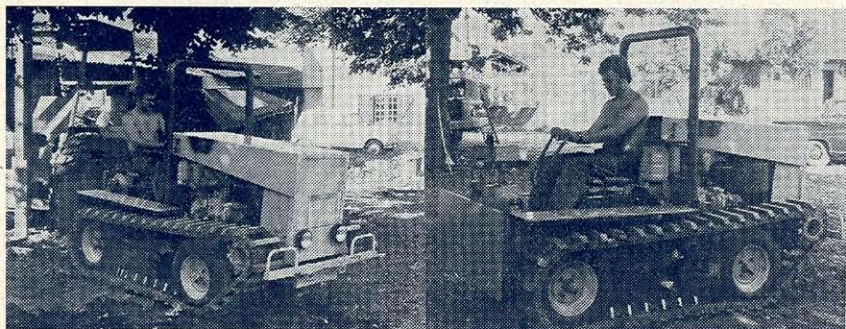
3. ábra. CF 500 láncaltalpas közelítő traktor 35 lóerős
