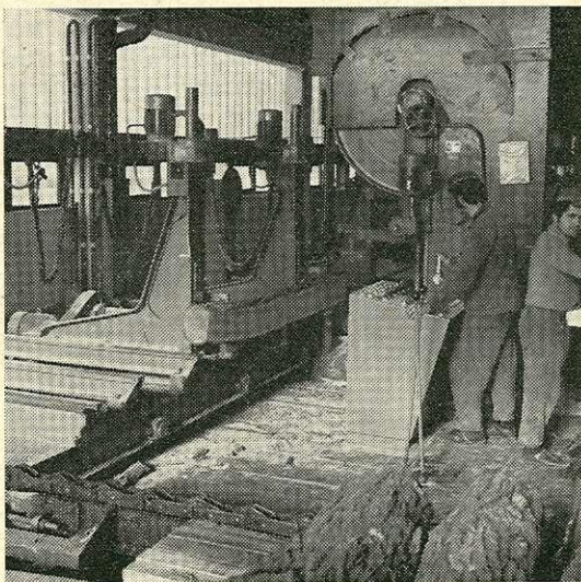
5. ábra. TA—1400 rönkvágó szalagfűrész a Fűrész- és Hordóipari Vállalat ceglédi üzemében
