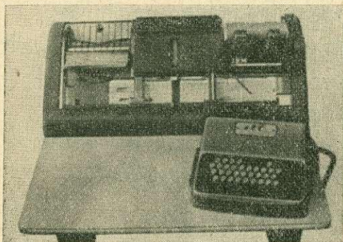
2. ábra. IBM 024. típusú lyukasztógép
