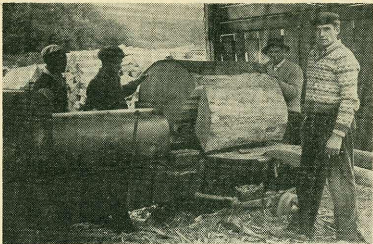
3. ábra. A központi rakodókon a vastagfa hasítását hidraulikus hasogatógép végzi el
