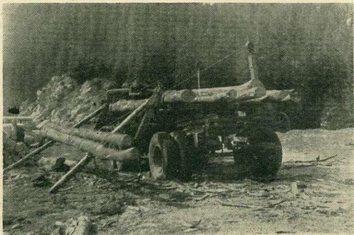
4. ábra. A hosszúfa rakodása kétdobos csörlő segítségével
