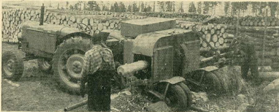
5. ábra: VK—16 jelzésű kéregzőgép munkában (foto: Valon Kone)
