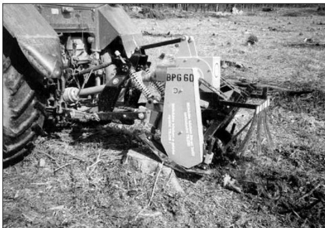
2. ábra. BPG-600 típusú forgókés-rendszerű pásztakészítő
