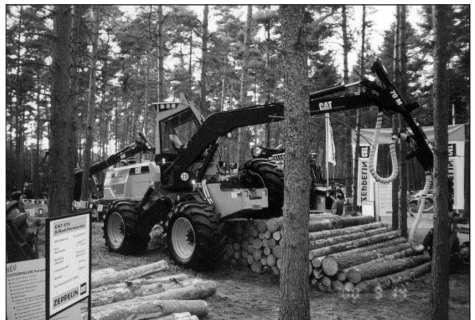
Nagy terepjáró képességű, kerekeiket önállóan beállítani tudó többcélú gép
