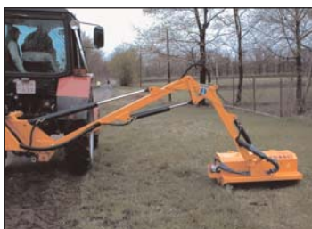
Rézsükasza három ponton felfüggesztve
