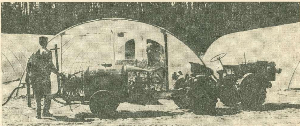
2. ábra. T4K—14 kistraktorra szerelt Minitox 3—2HP permetezőgép
